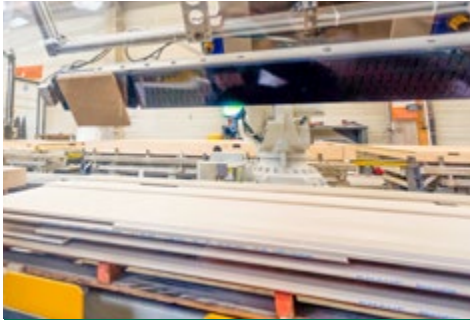
Erkennung und Ausschleusung von prozessbedingten Füllstücken
