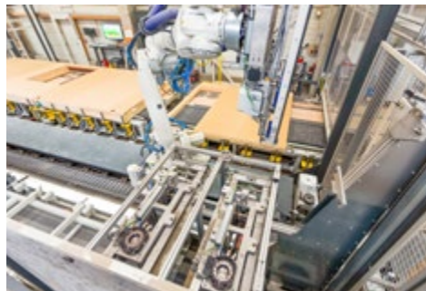
erneuter Greiferwechsel von Klammergerät zu Sauggreifer
