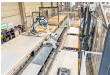
identischer Ablauf zur Bepunktung mit Gipsbauplatten
